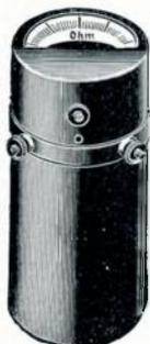
Diese Instrumente besitzen ein Drehspulmeßwerk und eine in Ohm geeichte Skala und dienen zur Feststellung von Defekten an stromlosen Leitern, sowie auch zur schnellen überschlägigen Messung von Widerständen. Bei Nachlassen der Spannung des eingebauten, leicht auswechselbaren Trockenelementes kann das Instrument durch einen magnetischen Nebenschluß einreguliert werden.
